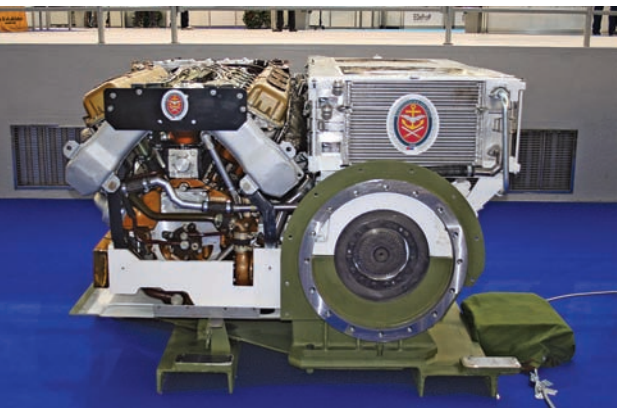
Интегрална погонска група за тенк М-84 са мотором од 1.200 КС
