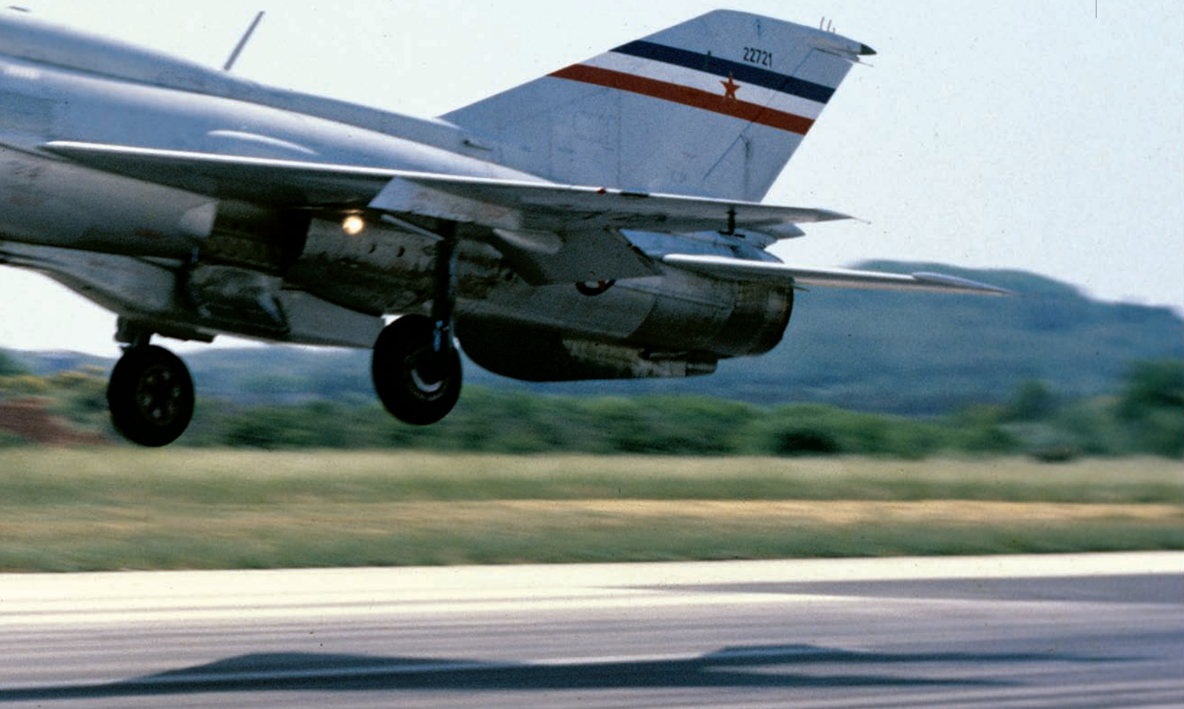
МиГ-21ПФМ из 129. ескадриле током слепања на аеродром у Пули 1986. године. На централном носачу видљив је подвесник ГП-9 са тобом ГШ-23 (МЦ „Одбрана“)
